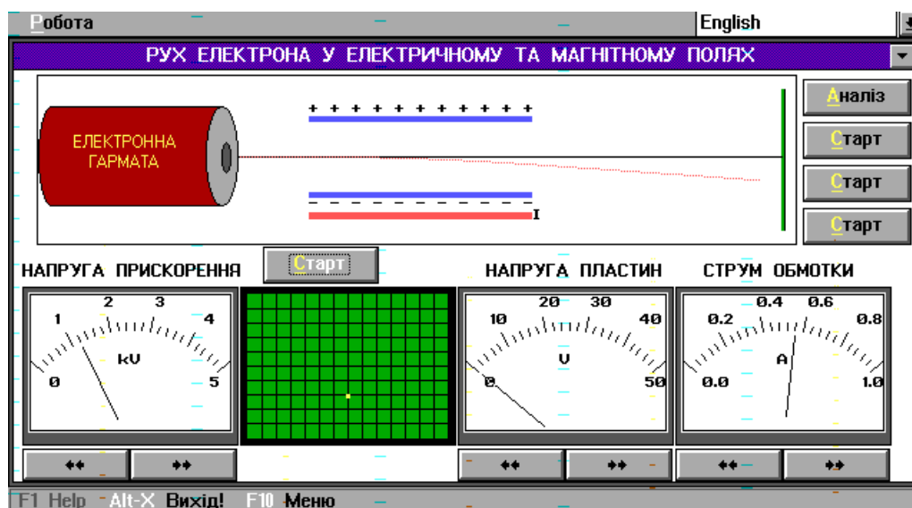
Рис.8. Електрон, прискорений різницею потенціалів 1,2 кВ, відхиляється в поперечному електричному полі, створеному напругою 30 В на горизонтально
